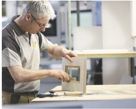
/ Die Rahmen für die Rahmen-Füllungsfronten werden aus einem Stück gefräst und von Hand nachbearbeitet. Der Fachmann weiß: Nur so lassen sich Lackabrisse und Verzug vermeiden.
