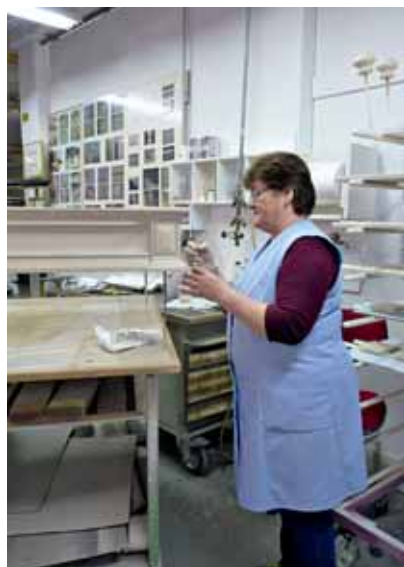
Viele Prozesse in der Produktion sind bei Reichert inzwischen über „2020 Insight“ verknüpft. Manche Holzteile, wie hier Elemente der Nobelküche „Versailles“, werden von den Mitarbeitern aber auch noch sorgfältig von Hand lackiert
