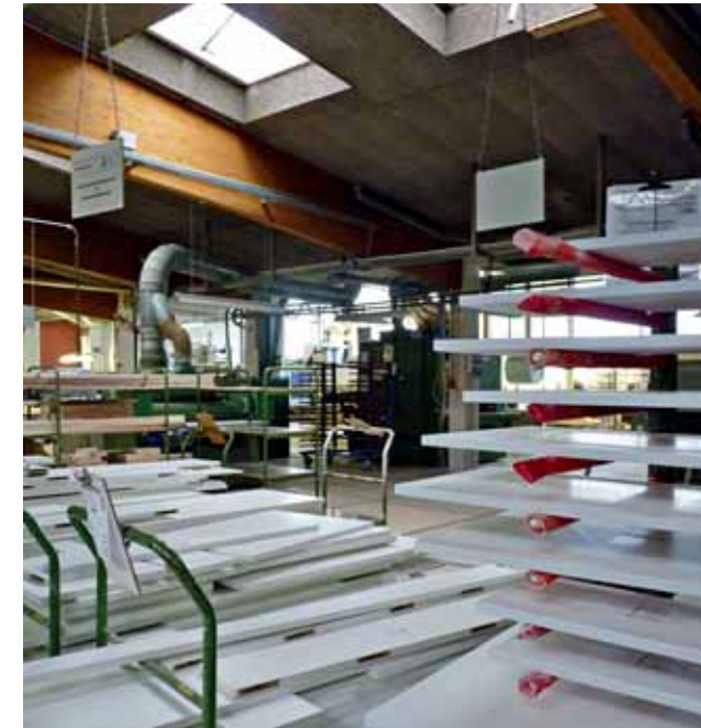
Auf dem CNC-Bearbeitungszentrum werden die Fronten gefräst und formatiert (links). Sobald die Fronten lackiert sind, lagert man sie auf einem der 800 Hordenwagen, bevor sie dann in den Versand gehen (rechts)
