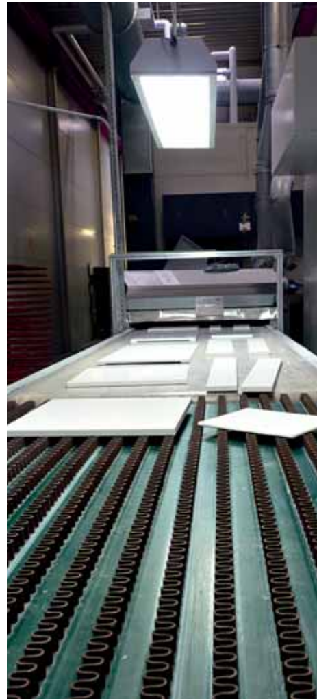
Etwa eine halbe Stunde dauert der Weg der Fronten durch den Lackierautomaten und die UV-Trocknungsanlage
