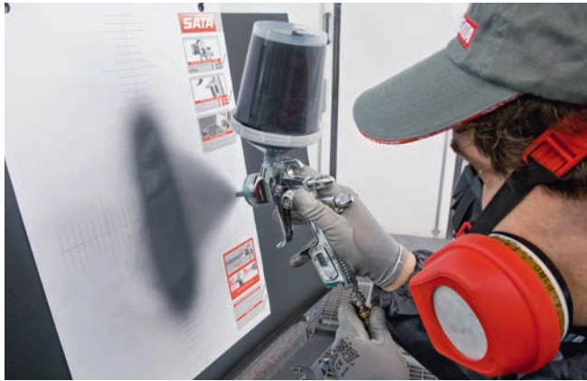
Mit Sata Cert lassen sich Referenzspritzbilder anfertigen und archivieren
